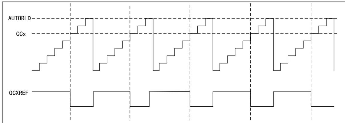
图 50 PWM1 向下计数模式的时序图
