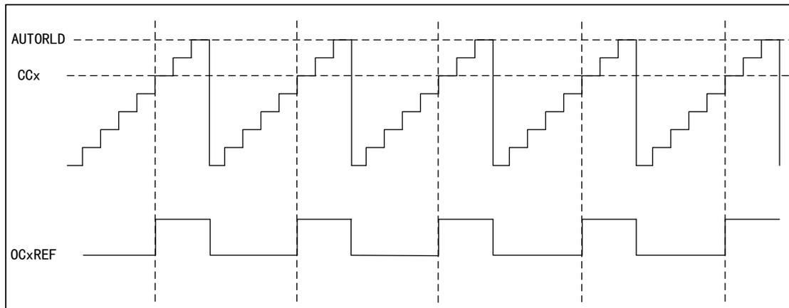
图 32 PWM2 向下计数模式的时序图
