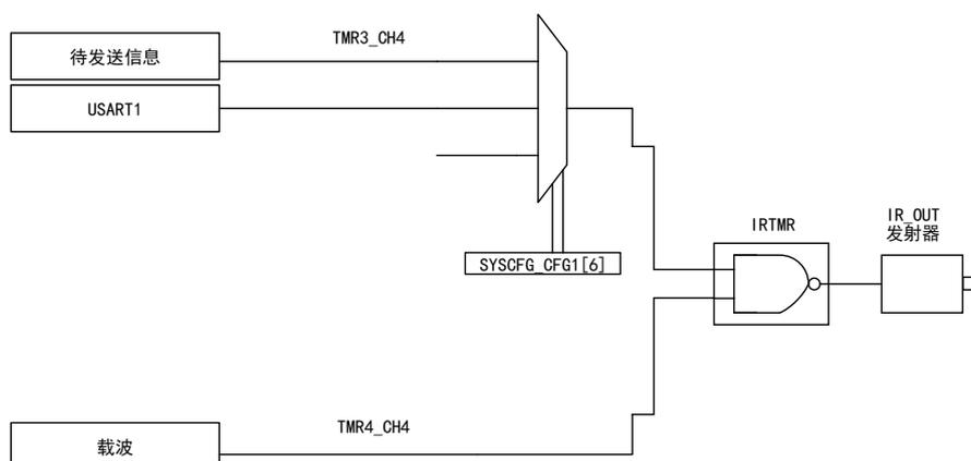
为了产生正确的红外遥控信号，需要正确配置 TMR4\_CH4 提供一个高频载波信号，而 TMR3\_CH4 提供我们发送的信息或者通过配置 SYSCFG\_CFG1 寄存器的 IRSEL 位选择 USART1 来产生调制包络。
