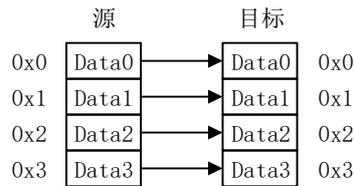
图 10 源为 8bits 目标为 16bits 的传输宽度
