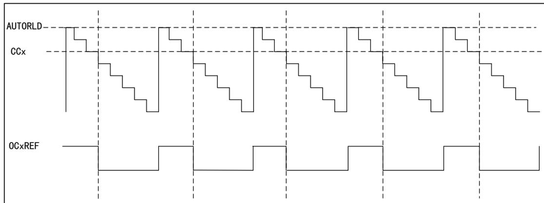
图 33 PWM2 中央对齐模式的时序图
