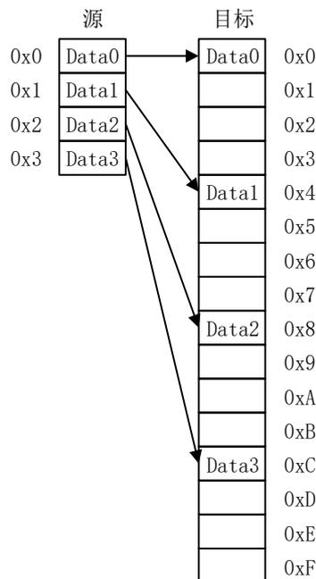
图 12 源为 32bits 目标为 8bits 的传输宽度
